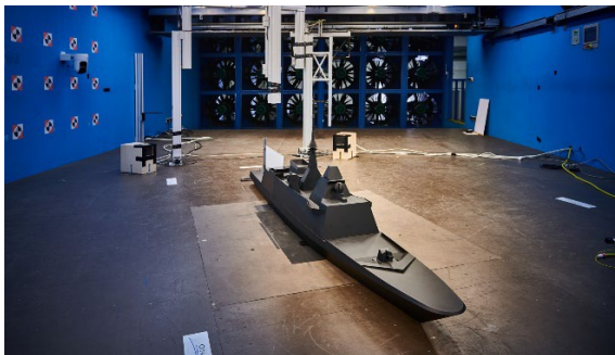
Figure 1 Photographie de la maquette de Frégate dans la soufflerie L2 (gauche) et illustration du maillage adaptatif du navire en simulation numérique (droite)
